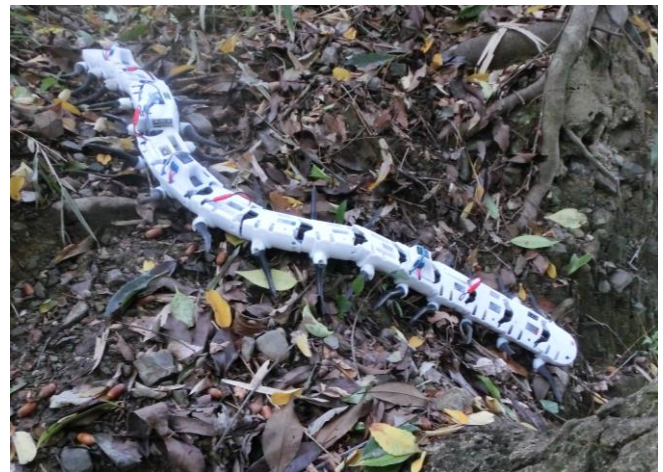
開発したムカデ型ロボット i-CentiPot
