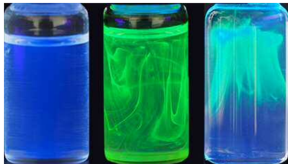
図1 左から低温状態、高温状態、高温から低温へ下げる途中の発光(紫外線照射下)
