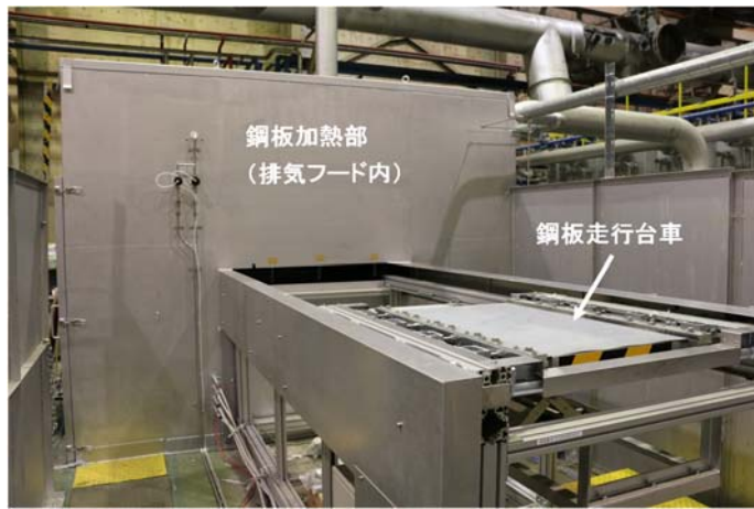
写真1 衝突噴流式鋼板脱脂設備 (設備全体)
