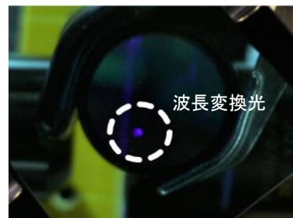
図3 微小共振器デバイスで発生した波長 428 nm の青紫色光
