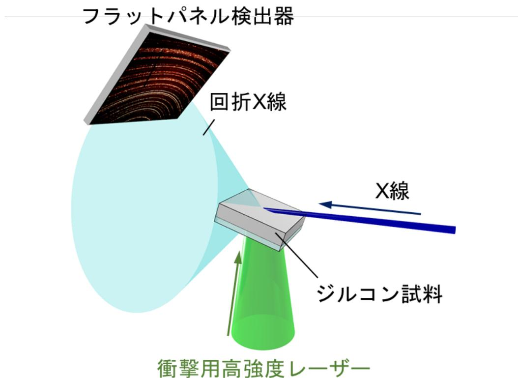
図1 レーザー衝撃圧縮実験の概略図
