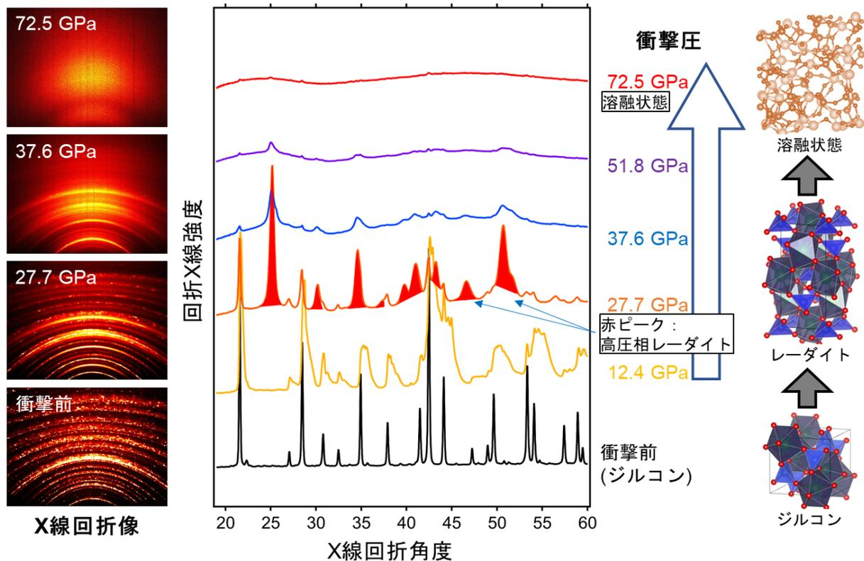
図2 高強度レーザーパルスエネルギーごとのX線回折スペクトル変化。照射エネルギーの増加に伴いより強い衝撃状態が発生される。27.7GPaで高圧相レーダイトが見られるようになり、72.5GPaで溶融状態に変化した。
