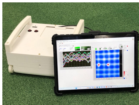
完成したハンディ鉄筋スキャナのプロトタイプ
