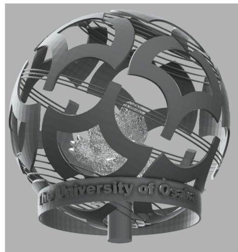
図3 金属3Dプリンタ技術で製作された旗の先端部
