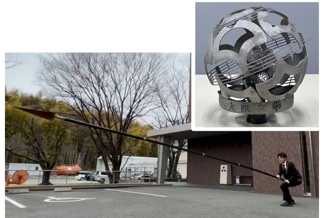
図1 CFRPで製作された新団旗のポール部と、金属3Dプリンタ技術で製作された旗の先端部
