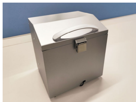
ペプチドシークエンサーの実機
